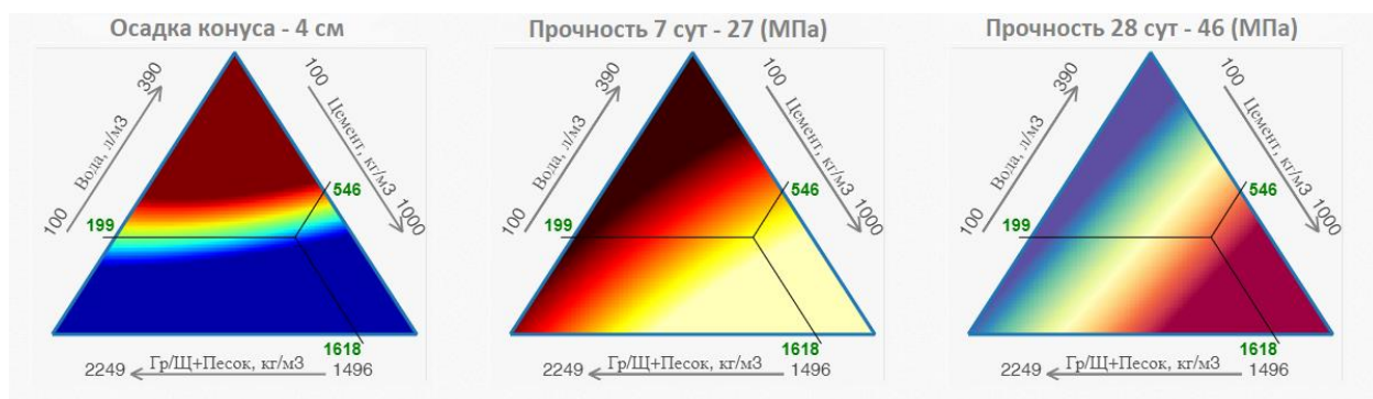
Рисунок 4.6. Проектирование контрольного состава бетонной смеси [172, 208]
