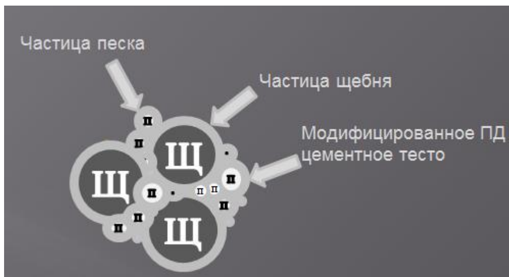
Рисунок 4.1. Физическая модель формирования структуры бетона
