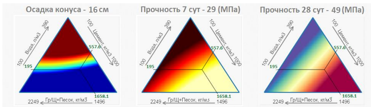
Рисунок 4.8. Проектирование контрольного состава бетонной смеси [172, 208]
