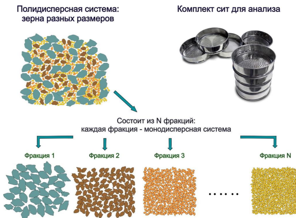
Рисунок 4.3. Разложение полидисперсного материала в виде совокупности монодисперсных частиц
