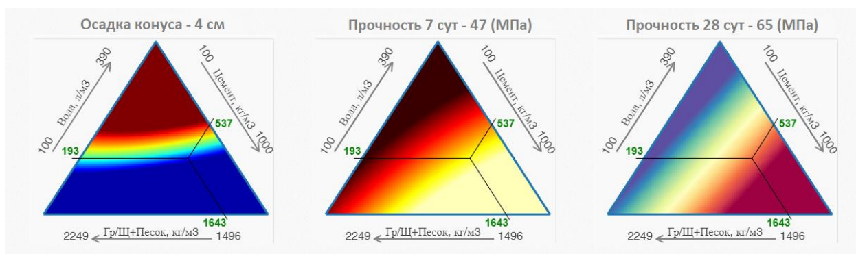
Рисунок 4.7. Проектирование состава смеси модифицированной бетонной смеси [172, 208]
