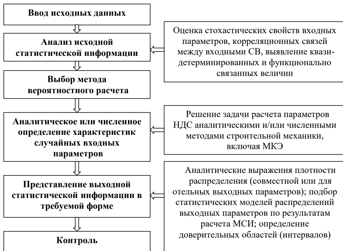
Рисунок 1.3 – Алгоритм решения прямой задачи вероятностного расчета
