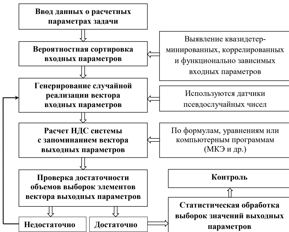
Рисунок 1.2 – Алгоритм вероятностного расчета методом МСИ
