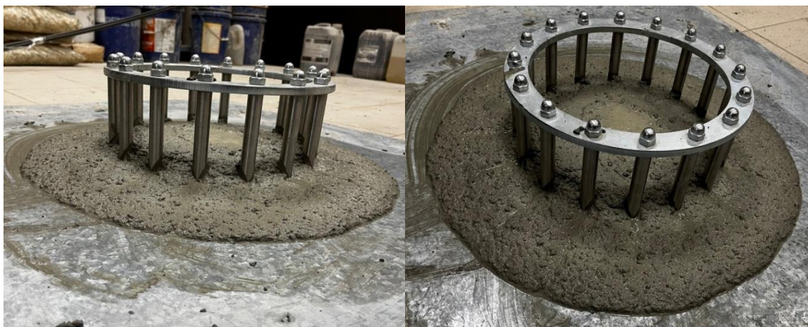
Рисунок 4.16 – Определение текучести при помощи блокирующего кольца
