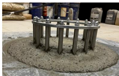
Рисунок 18 – Определение текучести при помощи блокирующего кольца
