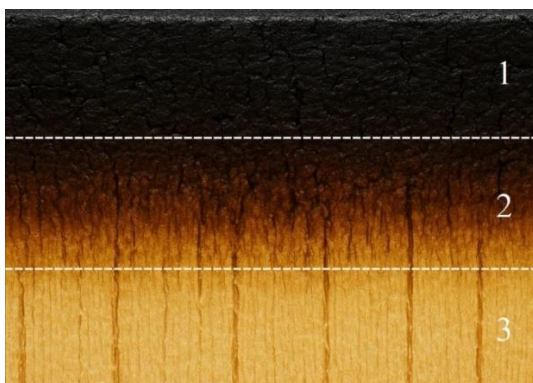
Рисунок 4.3 – Модель слоев приповерхностной области древесины после плазменной обработки: 1 – соответствует стадии окончания пиролиза, имеет черный окрас и представляет собой углерод; 2 – соответствует начальной стадии пиролиза и представляет собой результат разложения исходного материала каркаса; 3 – представляет собой исходную древесину
