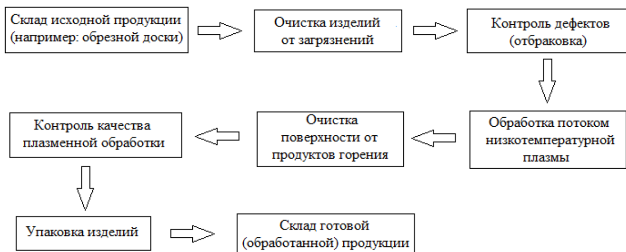
Рисунок 5.2 – Технологическая схема производства работ по обработке изделий из древесины потоком низкотемпературной плазмы
