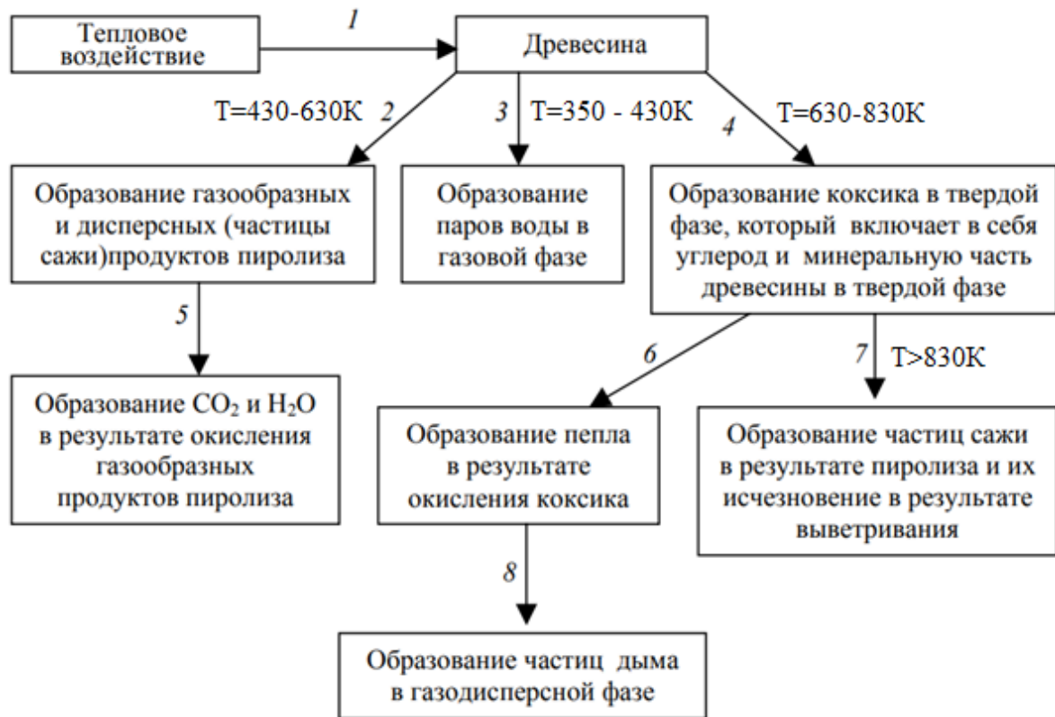
Рисунок 3.1 – Схема изменения агрегатного состояния и химического состава древесины при ее горении. Стрелки обозначают: 1 – подвод тепла в результате излучения, конвекции и теплопроводности; 2 – образование газовой фазы в результате пиролиза древесины; 3 – сушка древесины; 4 – образование твердой фазы в результате пиролиза древесины; 5 – окисление газообразных и дисперсных продуктов пиролиза; 6 – образование пепла; 7 – образование и исчезновение частиц сажи; 8 – образование частиц дыма и их выветривание
