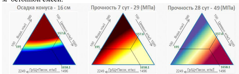
Рисунок 11 – Проектирование контрольного состава бетонной смеси
